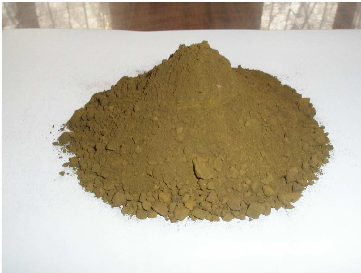
3 Сурет – 0-5 мм фракцияға дейін ұсақтаудан және ұсақтаудан кейін бастапқы темір кені
